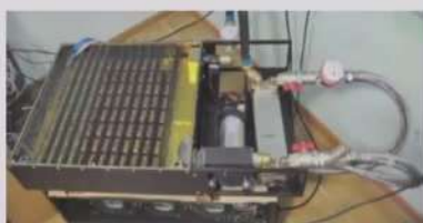
Levin等采用改良后的矿物油MD-4.5设计的液冷系统
